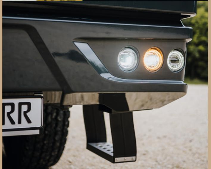
**LED-Arbeitsbeleuchtung zur optimalen Ausleuchtung des kompletten Arbeitsbereichs.**
